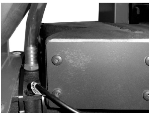
Obr. 6. Hadice se spojkou našroubovanou hrdla na podavači
