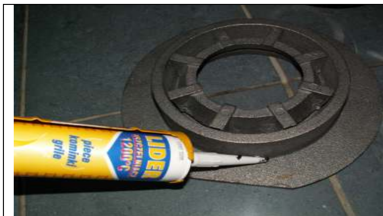
FOT 1 Uszczelnienie talerza paleniska retorty silikonem na temp. 1400°C.
