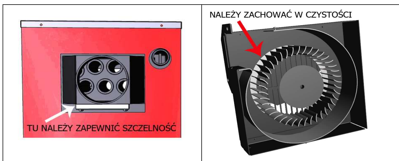
Rys. nr 14. Szczelność wyczystki oraz czystość wentylatora.
